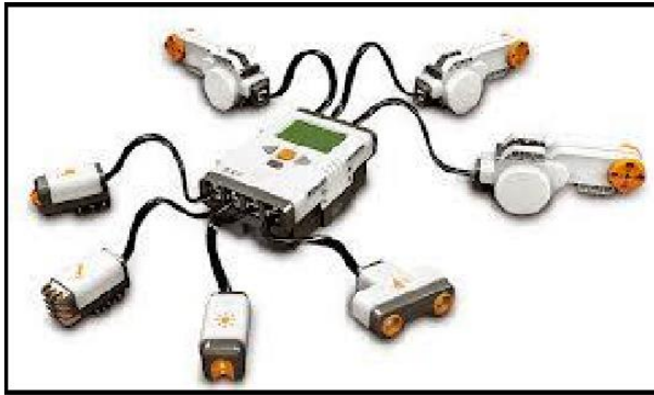
Figura 1. Diferentes tipos de sensores los cuales mandan la señal a un mismo punto.
