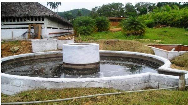
Figura 3. Biodigestor de cúpula fija con laguna de compensación sobre o biodigestor.
