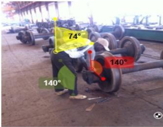
Figura 3. Operación de desarme de las cajas de grasa.
