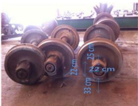
Figura 5. Dimensiones de la caja de grasa.
