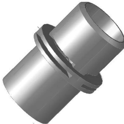
Fig. 6. Camisa modelada en 3D con el material asignado
