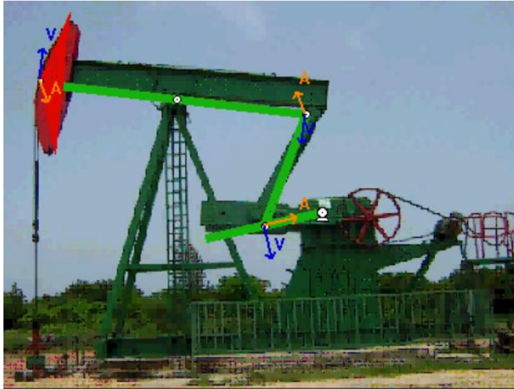
Figura 2: Análisis Cinemático atreves de Working Model
