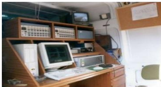
Fig. 2. Equipo computarizado para la obtención y análisis de datos provenientes de la prueba de carga.
