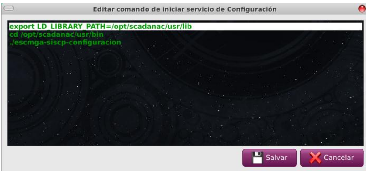
Figura 3. Interfaz gráfica para editar el comando para operar sobre un módulo del SCADA SAINUX.
