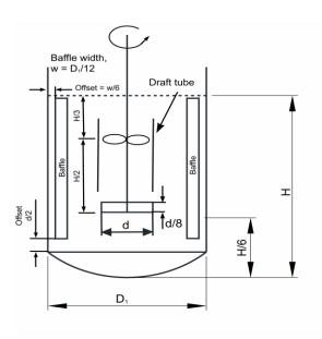
Figura 1. Tanque de agitación con dimensiones típicas (Quispe, 2014).
