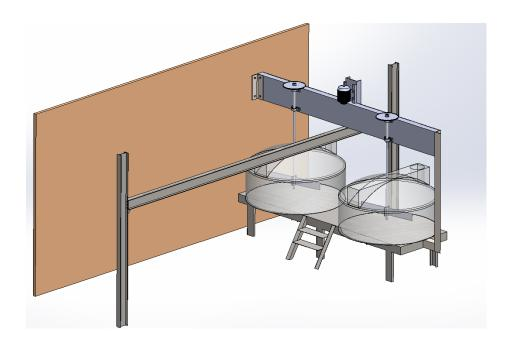
Figura 1: Mecanismo de agitación propuesto
