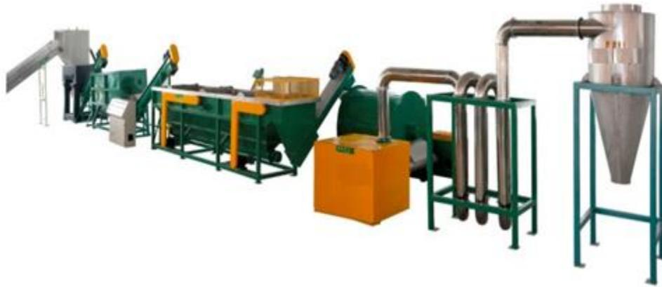
Instalación de corte, lavado y secado, fase inicial para el reciclado de termoplásticos
