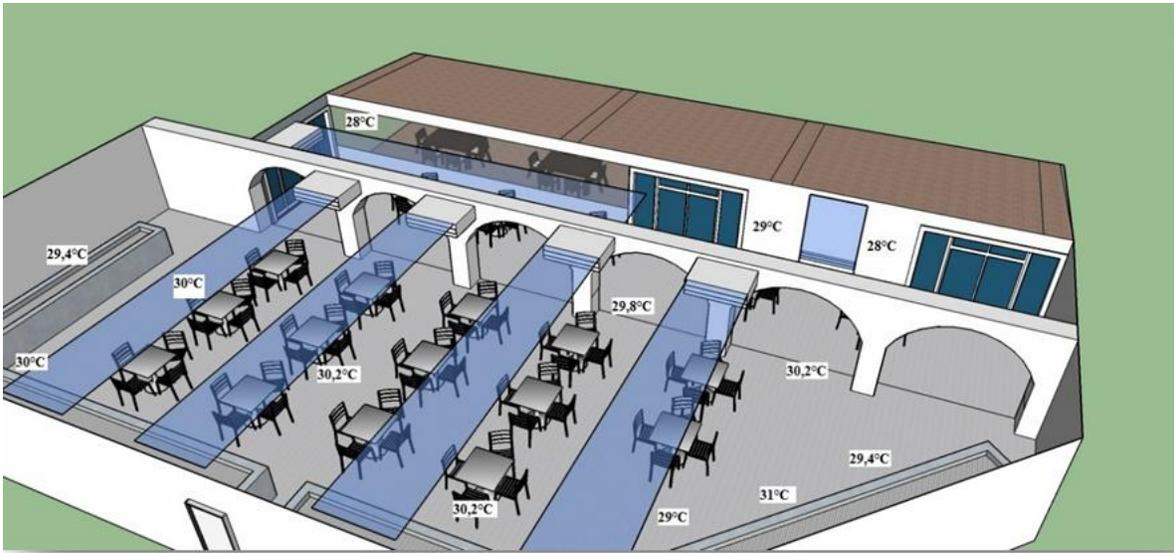
Figura 5. Distribución de temperaturas y amplitud del chorro de aire.
