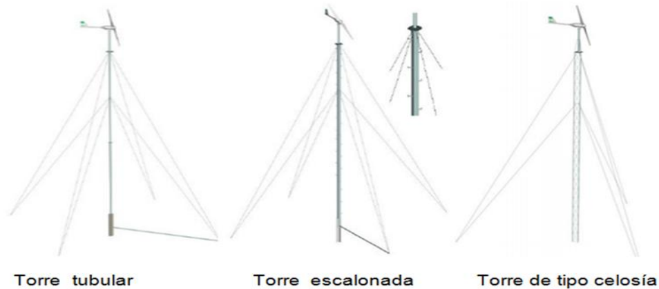
Figura 6.- Tipos de torres basculantes. Fuente [Guide for Design of Steel Transmission Towers, Tipos de torres para máquinas eólicas]
