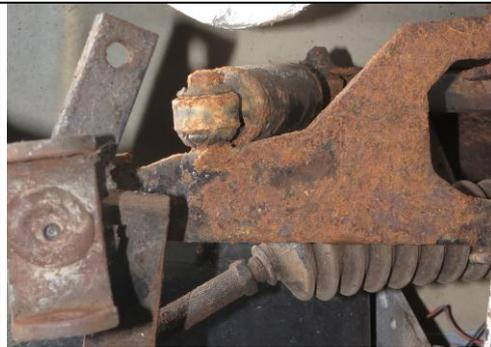
Figura 17. Corrosión atmosférica en la dirección del carro.
