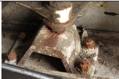
Figura 5. Área inaccesible en la pieza encargada de unir la carrocería con el chasis del carro.
