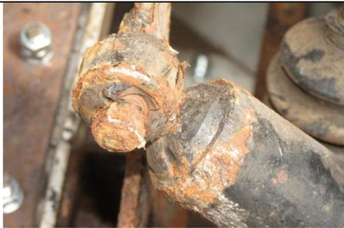
Figura 16. Corrosión interfacial y por resquicio u orificio en el extremo superior de la suspensión del carro.
