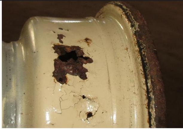
Figura 14. Llanta en desuso picada por la corrosión desde su interior.
