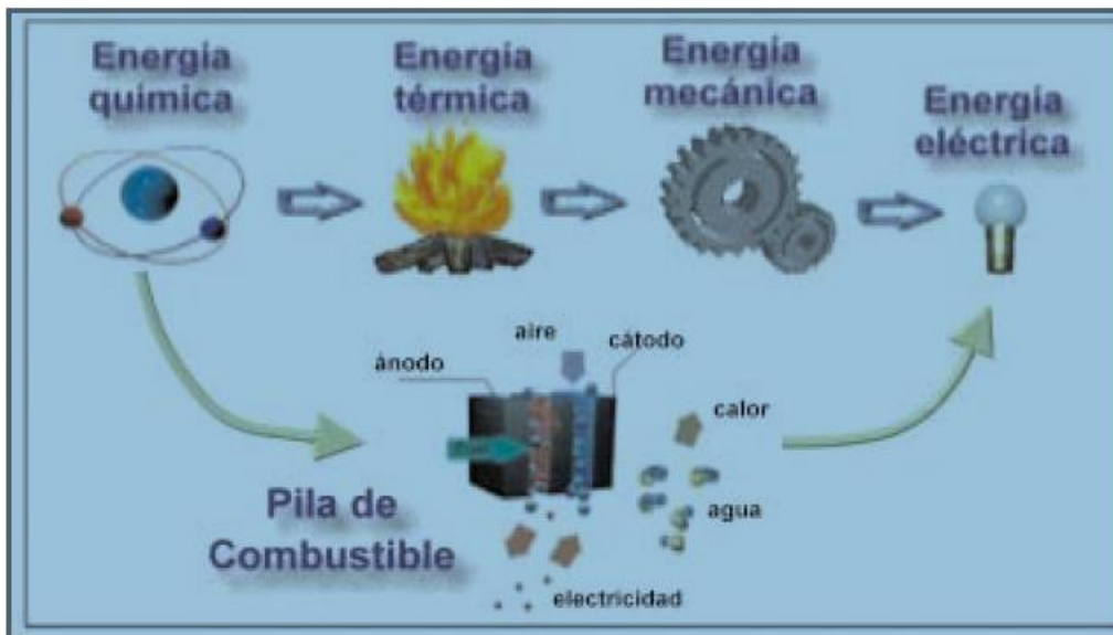
Figura 1 Esquema mostrando la transformación de la energía química en eléctrica, por medio de los procesos tradicionales de generación eléctrica y por medio de una pila de combustible.
