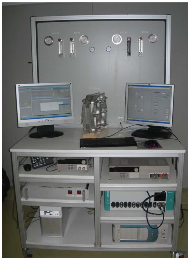
Figura 13 Banco de ensayos Dual para pilas tipo PEM diseñado y fabricado por especialistas del LITEC.
