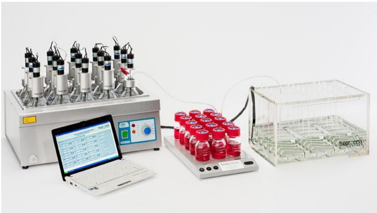
Figura: 3. Sistema Automático de prueba para Potencial de Metano (AMPTS).
