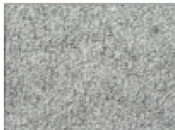
Fig. 14. grado de preparación Sa 2 ½, de acuerdo con la Norma (UNE-EN ISO 12 944-4 ,998)
