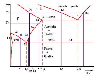
Diagrama 2: Comportamiento de la difusión del carbono y la estructura final en la aleación analizada en el ejemplo anterior de acuerdo a la zona de calentamiento.
