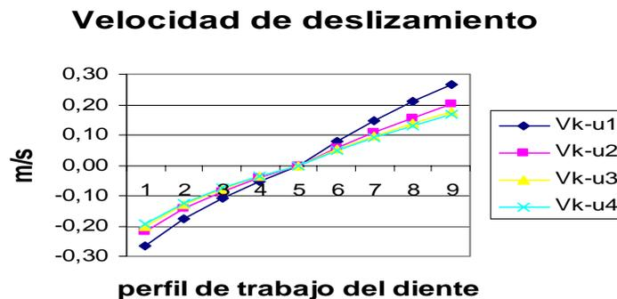
Figura 9. Resultados del cálculo de la velocidad de deslizamiento,  $V_k$ , para todas las variantes
