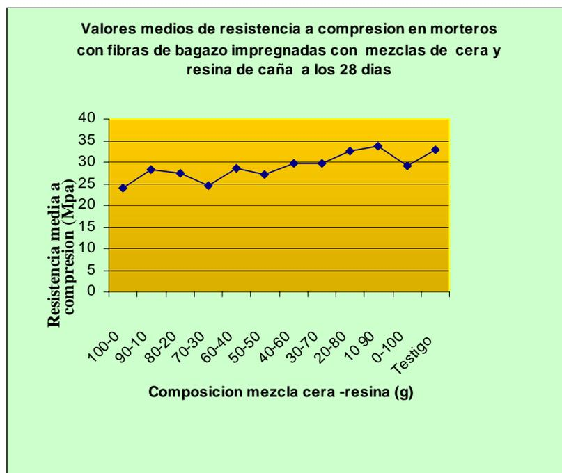
Fig. 6. Valores medios de resistencia a compresión en morteros con fibras de bagazo impregnadas con mezclas de cera y resina de caña a los 28 días
