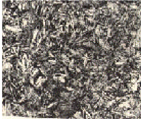
Figura 7 Estructura de Bainita de un acero AISI 1080 (300X).
