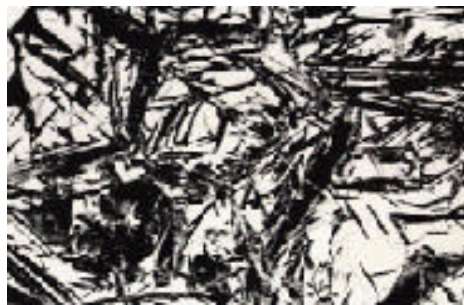
Figura 6 Estructura de Martensita de un acero AISI 1080 (300X).
