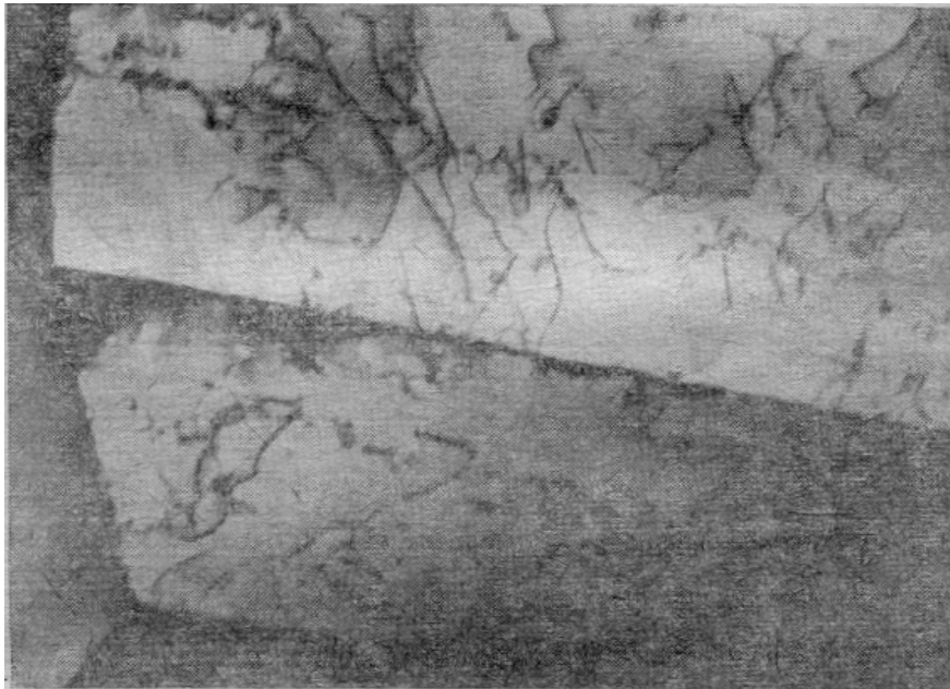
Microfotografía de las huellas de las dislocaciones, x 45 000.
